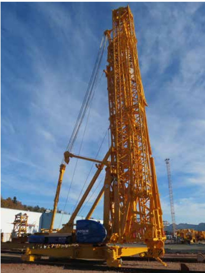
▼ Relevage hydraulique du mât
