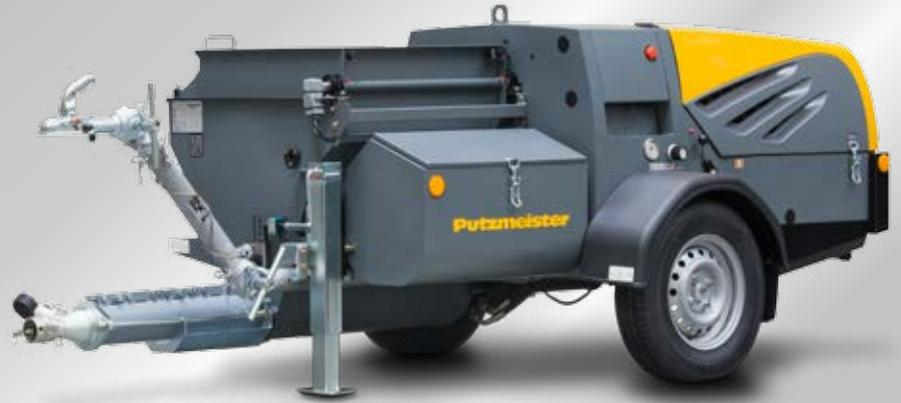
La SP 11 THF peut refouler le produit jusqu'à 100 m en horizontal et 60 m en vertical. Pour assurer le flux continu du produit, même pour les chapes à fibres synthétiques ou métalliques, le tamis-grille BBQ et le vibreur ont été améliorés. La pompe est ainsi capable de pomper jusqu'à 15 m<sup>3</sup>/h et répond vraiment à toutes les exigences des professionnels des chapes fluides.
