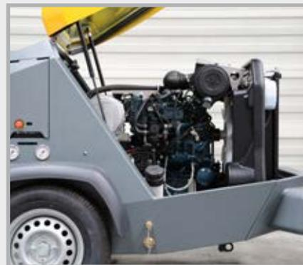
Le puissant moteur diesel turbocompressé de 37 kW avec filtre à particules est conforme au niveau d'émission « Stage V ». La pompe peut ainsi être utilisée sans difficulté aussi bien dans l'UE qu'en Suisse.
