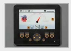
La gestion de performance en standard permet d'ajuster la puissance du moteur selon les besoins. Il est possible d'économiser du carburant ou d'obtenir de l'énergie supplémentaire.
